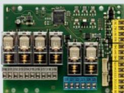
快速门控制箱可选多功能线路板:
